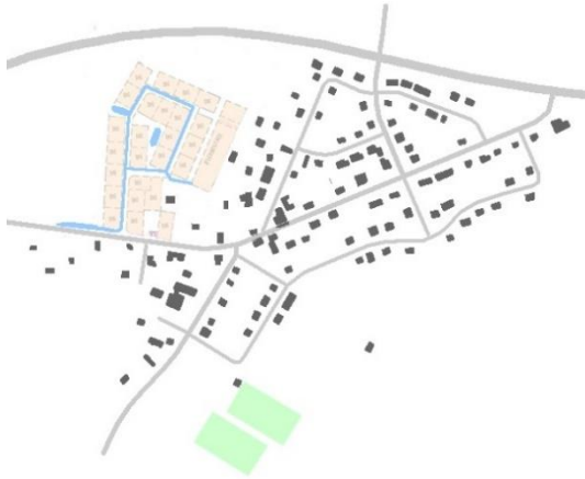
Bild 7 Villakvarterets vägdiken avses avvattna kvarteret samt även dagvatten från åsens västra sida. En uppsamlingsdamm om 3x30 meter inryms inom området för natur.
