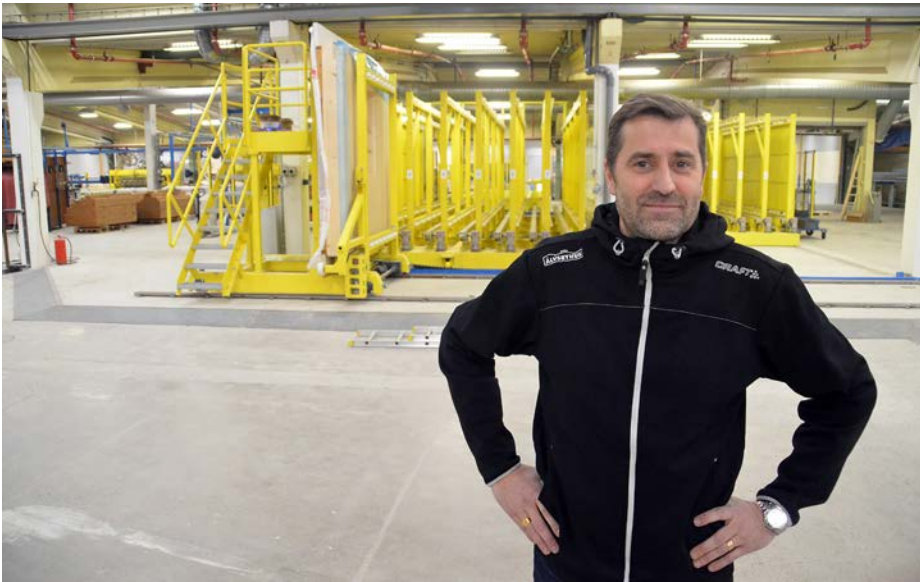
Stefan Johansson, bygg- och produktionschef, framför slutdelen av den nya vägglinjen (den gula konstruktionen). I facken levereras de färdiga väggelementen för att sedan med travers tas till monteringen.
