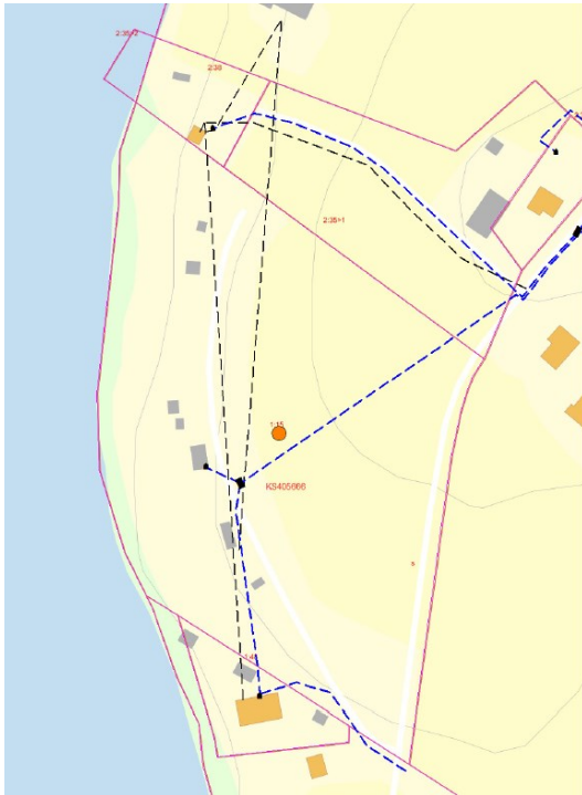
Figur 8. Befintliga elkablar i området Blå streckad linje = Lågspänning 400 V Svart streckad linje = Annan elkabel (Vattenfall 2016-11-18)
